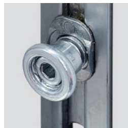
Schließzapfen (V) rollender anpressdruckverstellbarer Sicherheits-Pilzzapfen mit selbsttätiger Höhenverstellung
